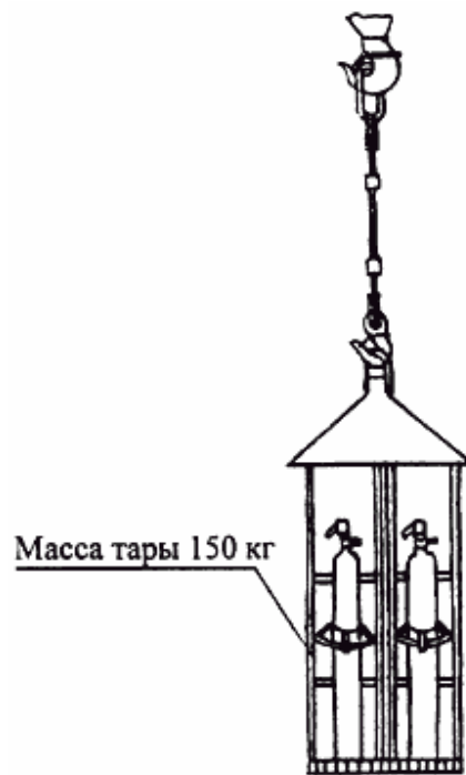
Строп 1СК-2,5 Q = 2,5 тс при подаче контейнера для хранения баллонов P = 750 кг
