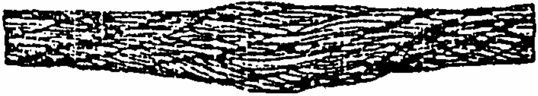
Рис.6. Местное увеличение диаметра каната
