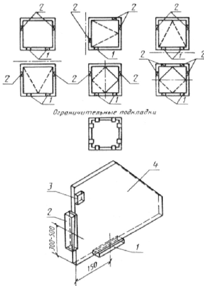
1 - опорная подкладка; 2 - фиксирующая подкладка;
